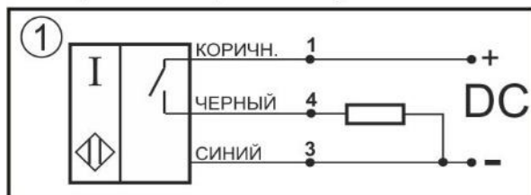
Схема соединения Нормально-разомкнутый контакт
